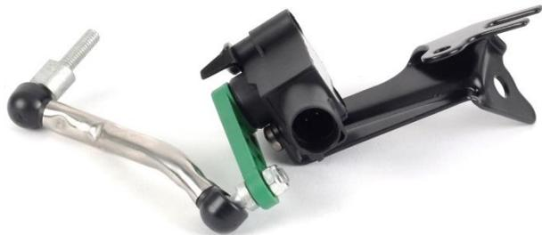
Die meisten Niveausensoren sind kontaktlos, d.h. es gibt keine Reibung, wodurch ein verschleißfreier Betrieb gewährleistet ist. Da sie jedoch außerhalb des Fahrzeugs montiert sind, sind sie den Klima- und Witterungsbedingungen ausgesetzt. Mit der Zeit kann Feuchtigkeit die Elektronik angreifen/schädigen und Fremdkörper wie Steine von der Straße können die Einheit ebenfalls beschädigen.
