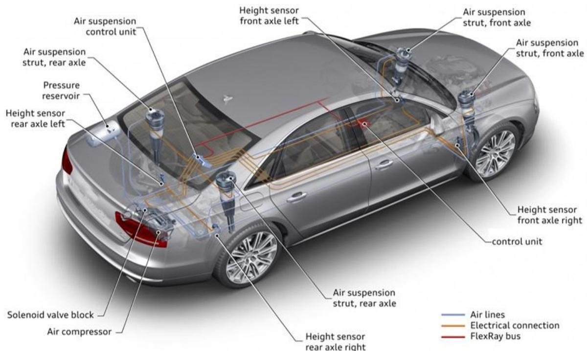
空气悬架系统的悬架支柱和减震器与传统的悬架系统相似，只是金属螺旋弹簧被空气弹簧取代。尽管如此，空气弹簧与螺旋弹簧的特性还是有所不同，因此减震设置的调谐方式也有所不同。
